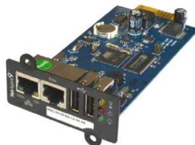
Внешний вид платы SNMP NetAgent 9 с 4 портами
