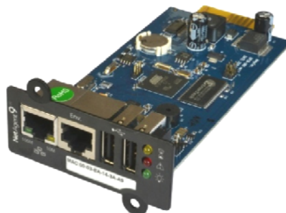
Внешний вид платы SNMP NetAgent 9 с 4 портами
